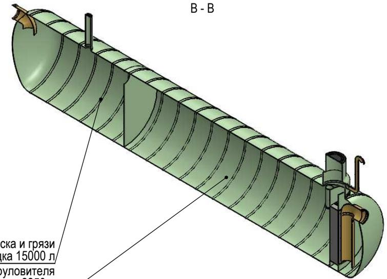
Камера для улавливания песка и грязи
